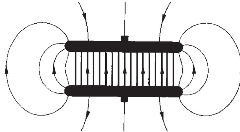
Condensateur à deux conducteurs à plaques parallèles
